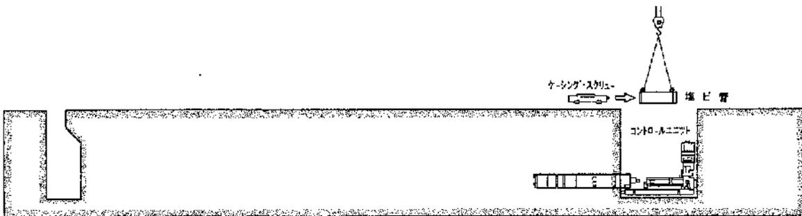
③ 駆動部を後退させ、ヒューム管(ケーシング・スクリューを内蔵)を接続します。
