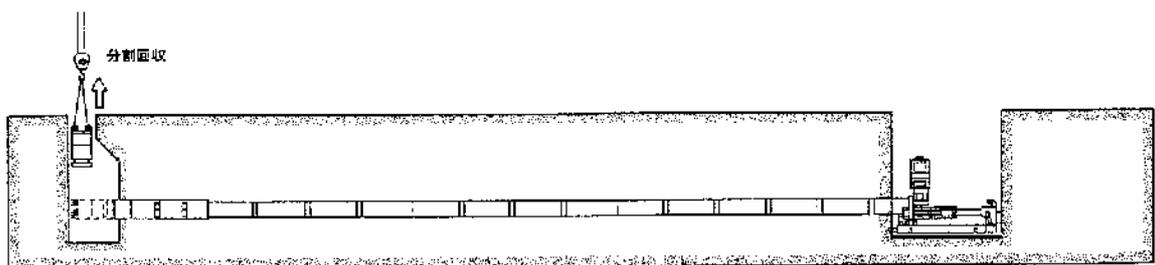
⑤ 先導体を到達坑から回収します。(到達が既設・最小寸法の場合は分割回収となります。)
